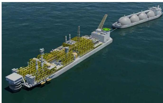
FLNG(浮体式天然ガス生産設備)からシャトルタンカーへの液化天然ガス移送
